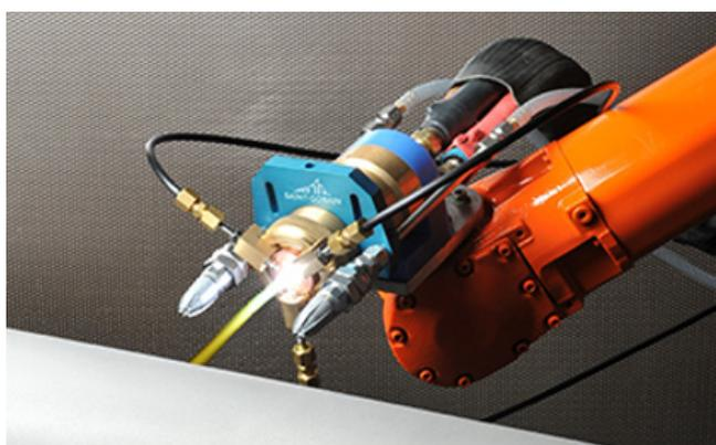
Foto 4 - Equipamento de metalização à plasma para colocar equipamento de metalização à chama otimizado - deposição de vários materiais, especialmente cerâmicos
