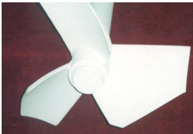
Foto 3 - Hélice de misturador revestida com  $Al_2O_3/Ti$
