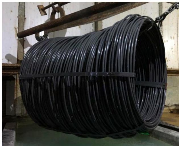
*Bobina de fio-máquina fosfatizado com banho de fosfato acelerado via nitrato/ions ferrosos*
