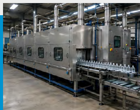
LINHA CONTÍNUA (TÚNEL)
