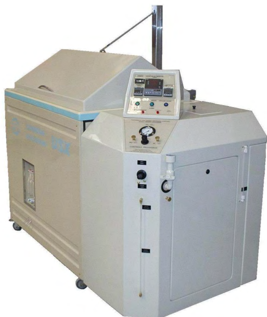
Figura 3: Câmara de Névoa Salina com a indicação dos sistemas de controle.
