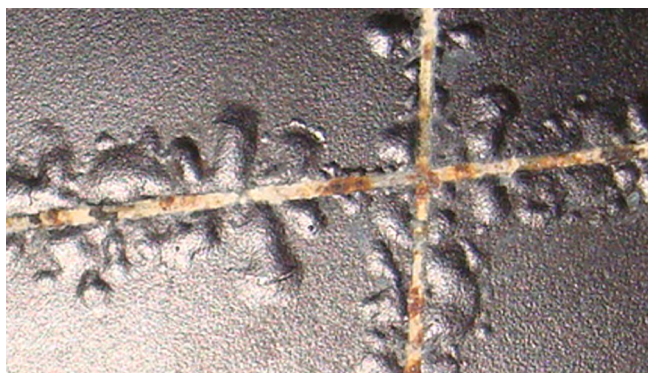
Figura 4: Placa de ensaio pintada após exposição ao ensaio de umidade saturada.
