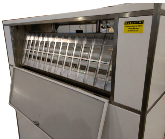
Figura 6: Indicação da câmara de exposição de ensaio UV com as lâmpadas de irradiação e os suportes para placas.
