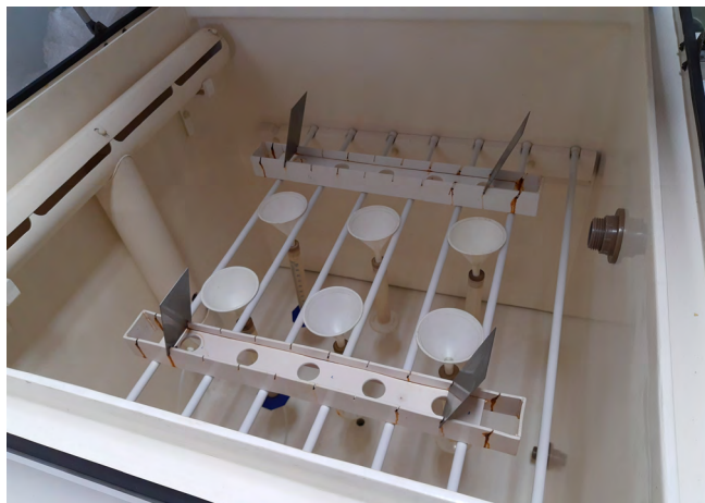
Figura 1: Interior da Câmara de Exposição Salina com funis para medição da coleta de névoa e cupons para a medição do grau de corrosividade.
