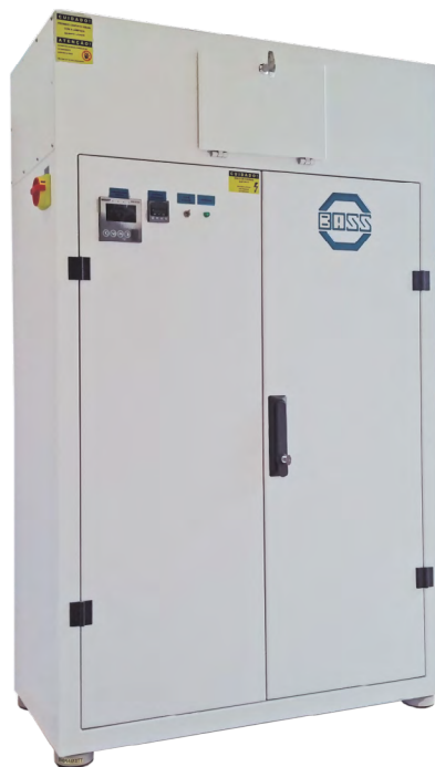
Figura 7: Exemplo de equipamento de ensaios de simulação solar com lâmpadas de Xênon.
