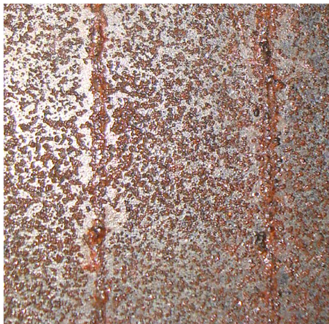
Figura 2: Placa de ensaio após exposição ao ensaio de névoa salina.
