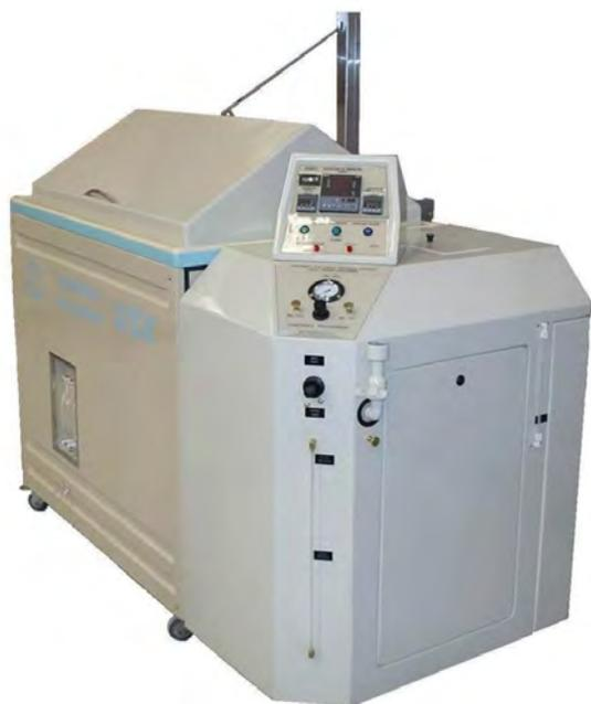
Figura 3: Câmara de Névoa Salina com a indicação dos sistemas de controle.
