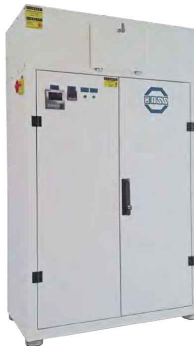
Figura 7: Exemplo de equipamento de ensaios de simulação solar com lâmpadas de Xênon.
