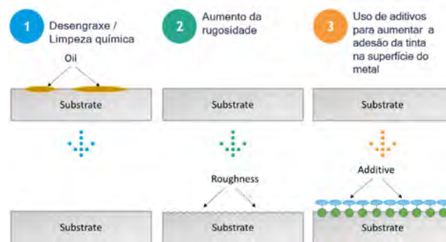
Figura 3. Esquema dos diferentes mecanismos para melhorar a adesão de tintas na superfície metálica.
