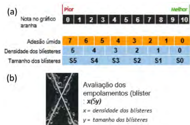
Figura: (a) Classificação dos testes de aplicação para a elaboração do gráfico aranha. (b) Avaliação dos empolamentos através da densidade e tamanho dos blísteres.
