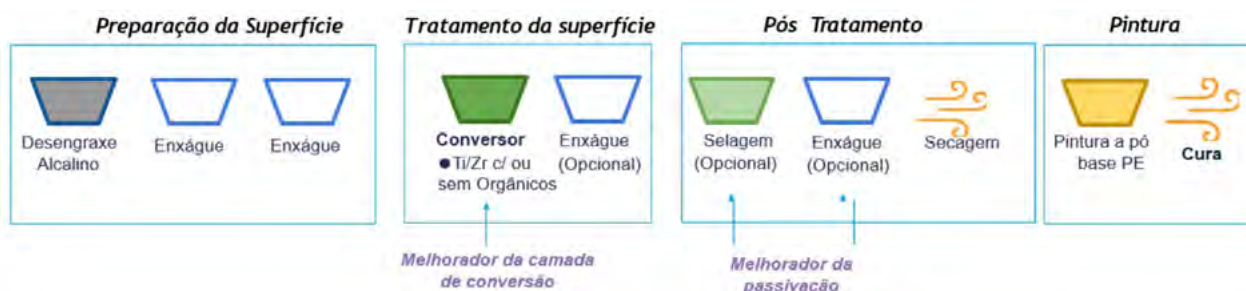
Figura 6. Esquema dos diferentes processos envolvidos no tratamento de HDG para pintura.
