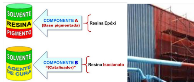
Desenho dos componentes de uma tinta Epóxi-isocianato e um painel pintado com a tinta (vermelho)
