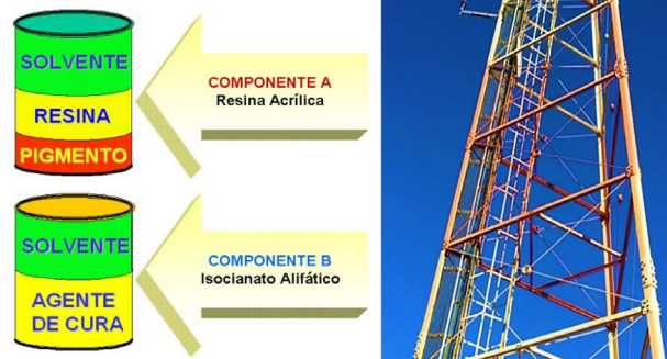
Desenho dos componentes de uma tinta de Poliuretano e uma torre pintada com Poliuretano DF
