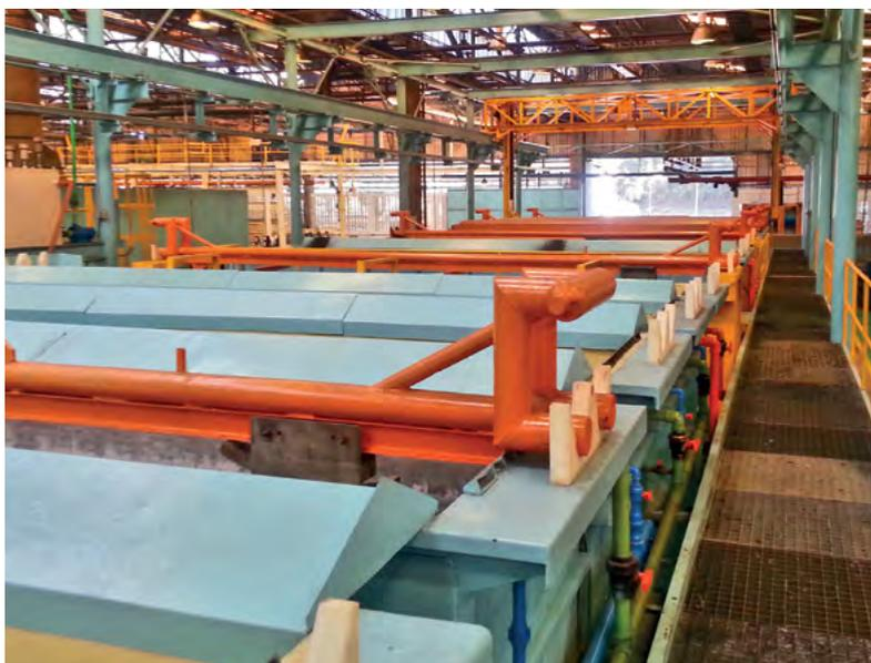
Capacidade de pintar peças de até 6.500 mm de comprimento por 1.400 mm de altura por 1.000 mm de largura, com peso de até 1.800 kg.
