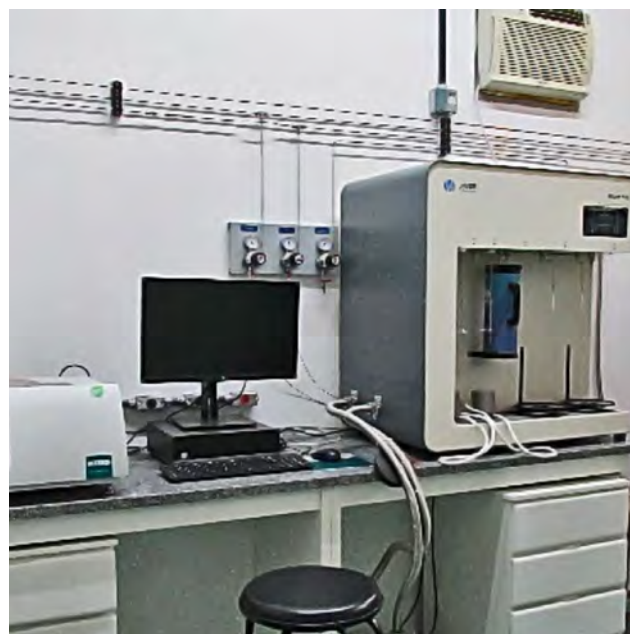
Acima, laboratório de teste de tintas e preparo de corpos de prova. Abaixo, sala do analisador por termogravimetria/DSC e o adsorvedor de \text{N}_2 para medida de área específica e tamanho de poros.
