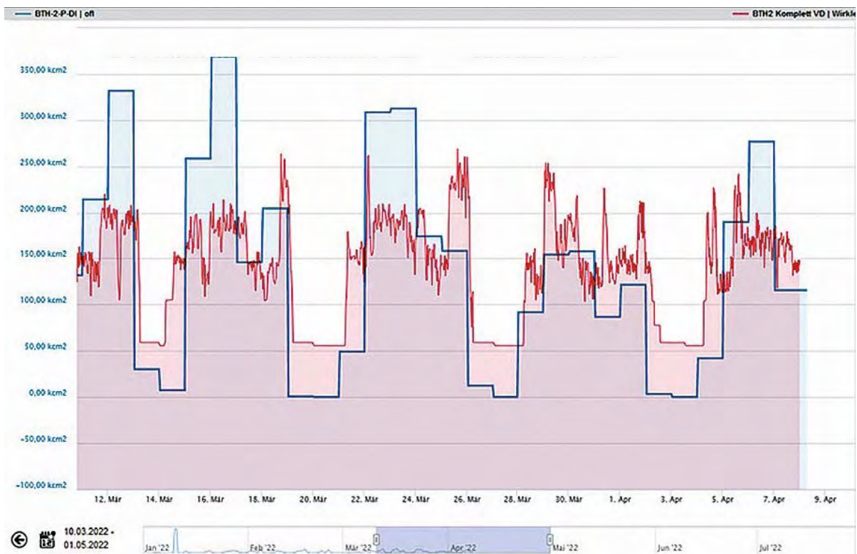
Fig. 4: As superfícies revestidas e a energia gasta podem ser colocadas em perspectiva usando a TI. (Gráfico: B+T Oberflächentechnik). Na imagem, o gráfico em azul representa a superfície tratada em kcm 2 e em vermelho, o consumo de energia em kWh. A alocação mais precisa do consumo de energia para a área de revestimento mostra se os processos de revestimento estão sendo executados corretamente ou, por exemplo, se ocorrem problemas de contato durante o fornecimento de energia para tambores ou racks ou, ainda, se os cálculos de área estão incorretos.
