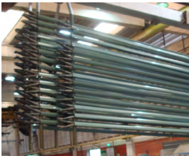
Figura 13: Anodização multicolor na cor verde.
