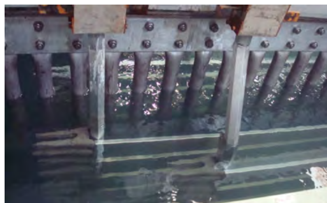
Figura 11: Anodização multicolor durante a etapa de modificação.
