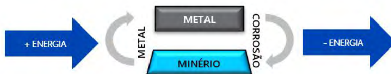
Figura 1 - Corrosão dos metais.
