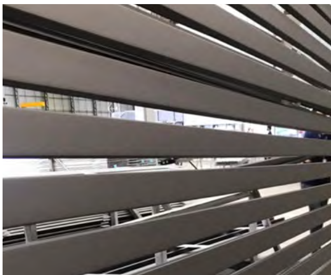
Figura 15: Anodização multicolor na cor titânio.
