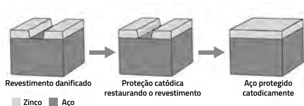
Figura 6 - Proteção Catódica.
