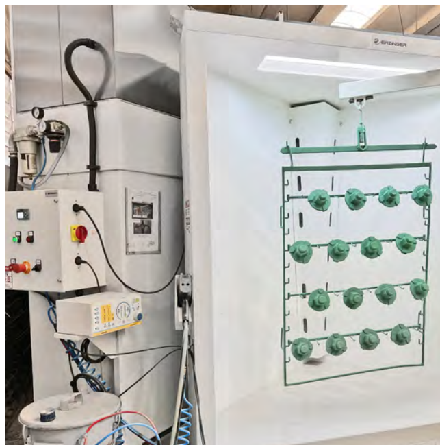
Nova cabine de pintura eletrostática a pó de troca rápida de cores: parceria Croma com Erzinger
