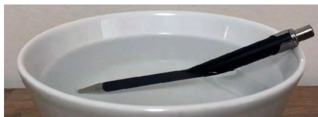
Lapiseira parcialmente imersa em água; ela parece torta devido à diferença do índice de refração do ar para a água.
