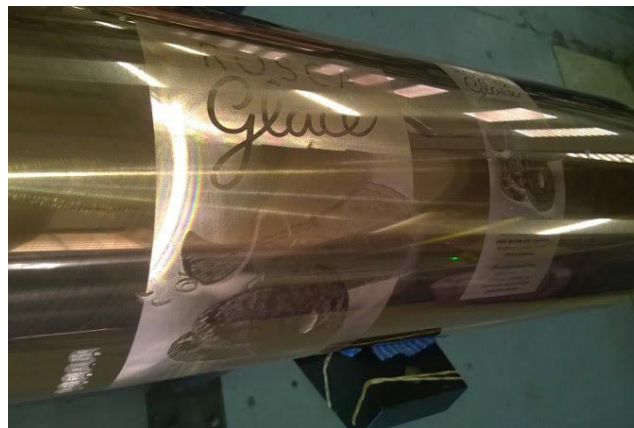
Cilindro rotogravura cobreado e gravado. Hanns se encantou com TS ao ver seu pai trabalhando com os cilindros
