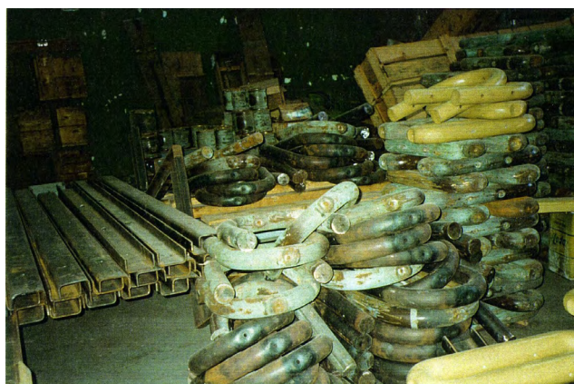
Foto 6 - Estrutura desmontada antes da metalização [Ref. 10.o]
