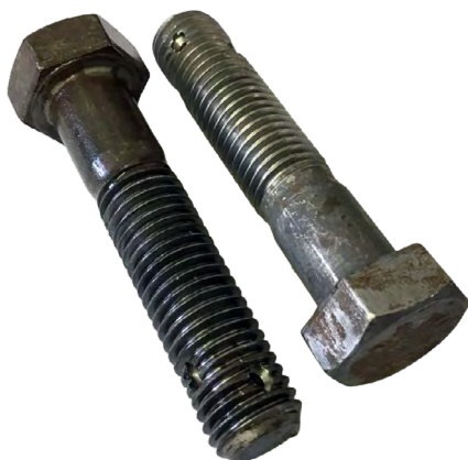
À esq., fixador ainda com presença de camada de fosfato. À dir., resultado após desfosfatização
