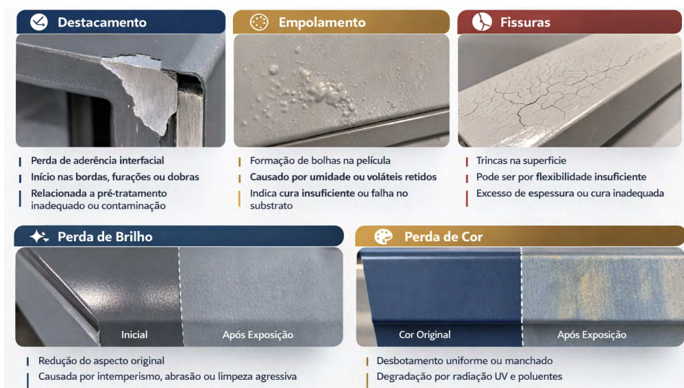
Figura 1 - Defeitos típicos em revestimentos orgânicos sobre alumínio.
