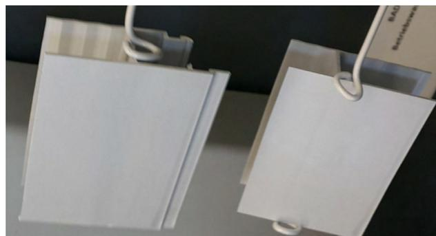
Peças que sofreram o processo de fosqueamento em alta concentração de Al, removendo completamente as linhas de extrusão, conferindo à superfície excelente acabamento.
