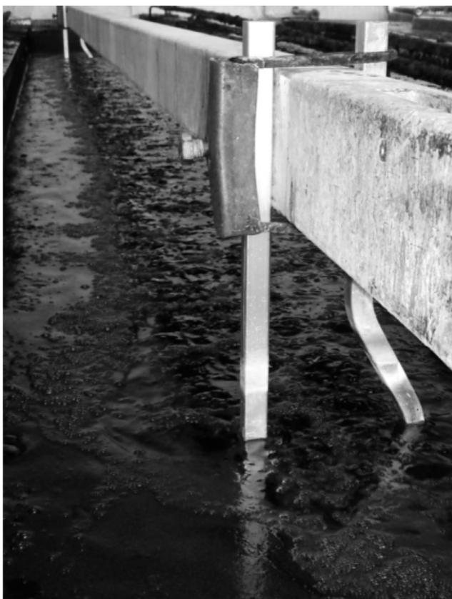
Aspecto visual de um banho com alta concentração de alumínio e baixa concentração de hidróxido de sódio. Baixa formação de espuma e excelente controle da reação.
