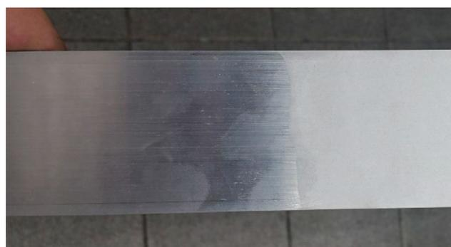
Comparativo da superfície antes (esquerda) e depois (direita) do processo de fosqueamento.
