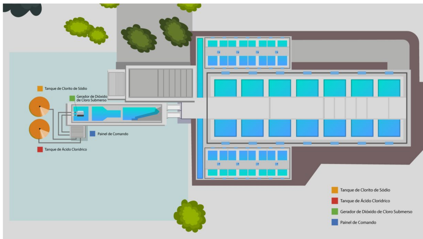
Modelo de instalação do gerador de dióxido de cloro para pré-oxidação em Estações de Tratamento de Águas
