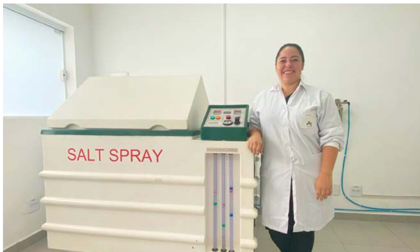
Bárbara R. Pasquati, Gestão da Qualidade, junto à Câmara de Salt Spray, onde são realizados os testes de resistência à corrosão de materiais e revestimentos
