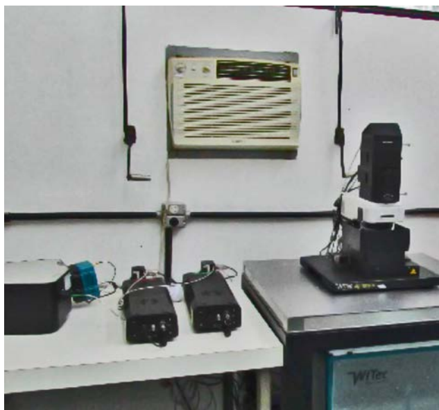
Acima, espectrômetro Raman provido de microscópio confocal com software de mapeamento por composição ( Raman Imaging ). Abaixo sala com vários equipamentos (FTIR, UVvis, Zetasizer e microscópio ótico).
