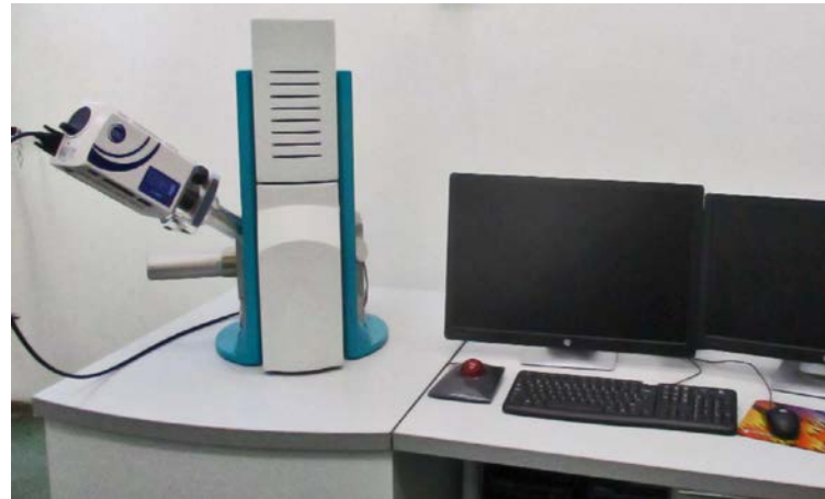
Microscópio eletrônico de varredura – MEV provido de analisador por EDS da Tescan
