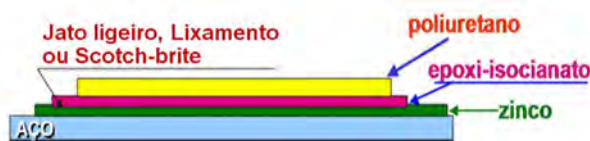
Exemplo de Pintura de aço galvanizado novo com Epóxi-isocianato
