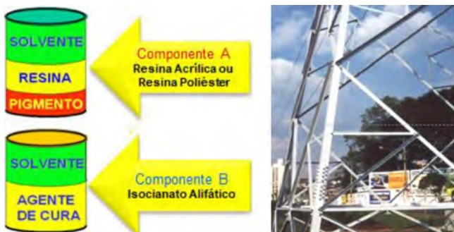
Desenho dos componentes de uma tinta de Poliuretano e torre pintada com acabamento Poliuretano
