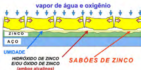
Desenho esquemático de como ocorre a saponificação da tinta alquídica e destacamentos
