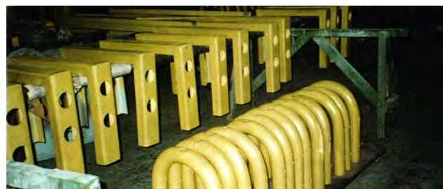
Foto 7 - Estrutura desmontada metalizada
