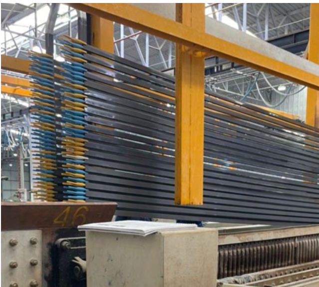
Figura 14: Processo multicolor em curso - anodização multicolor na cor titânio.
