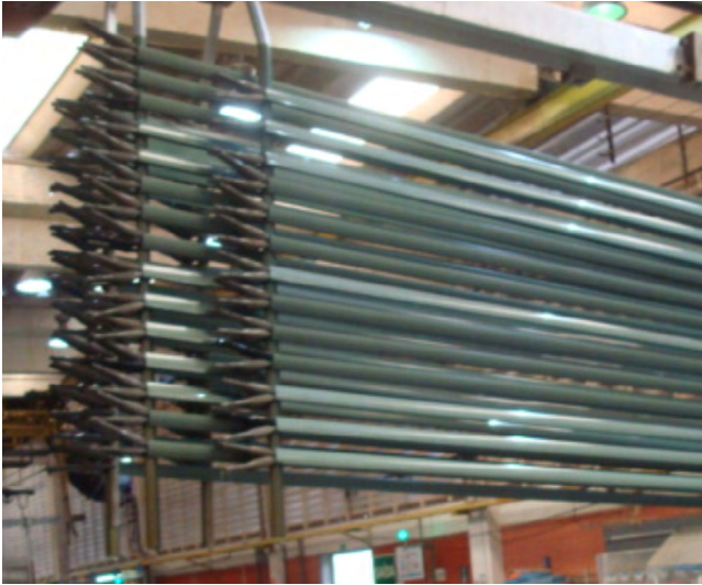
Figura 13: Anodização multicolor na cor verde.
