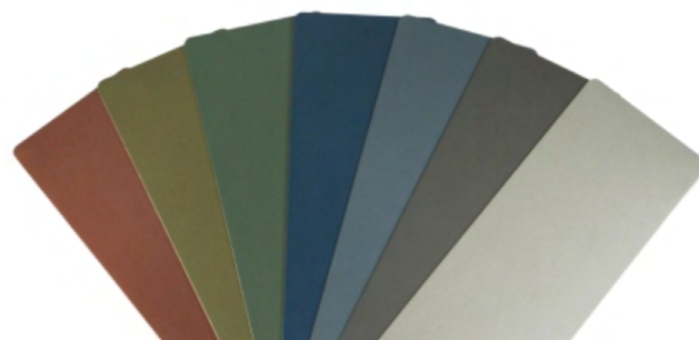
Figura 10: Cores obtidas na anodização multicolor: vinho, verde amarelado, verde escuro, azul, azul acinzentado, cinza e aço inox.
