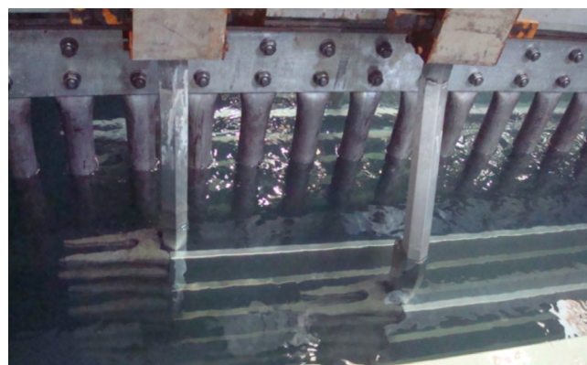
Figura 11: Anodização multicolor durante a etapa de modificação.
