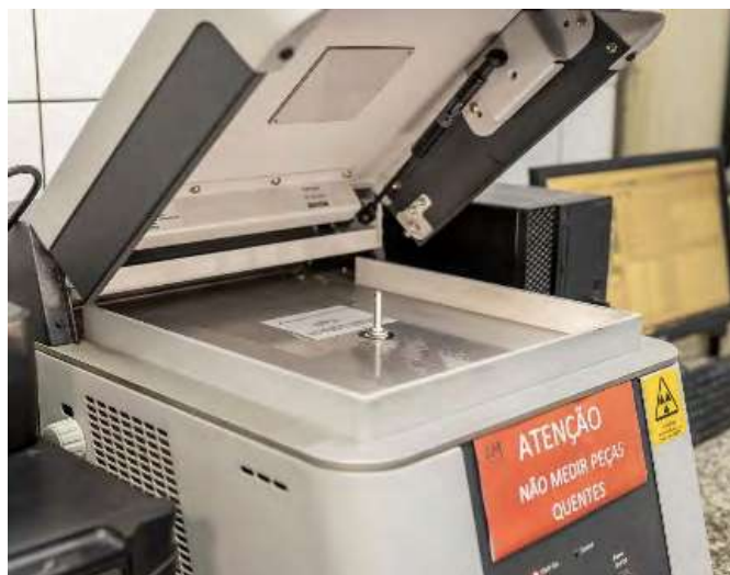
Medição da espessura das camadas das peças com aparelhos de Raio X, mantendo o padrão de qualidade
