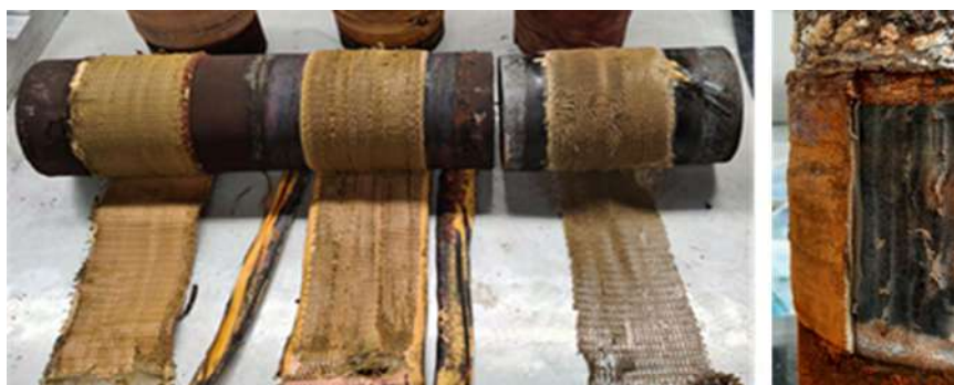
Figura 31 – Sistema à base de PIB para aplicações subaquáticas. Resultados dos testes após envelhecimento térmico em água do mar a 90 °C por 100 dias. Imagem à esquerda: Modo de separação coesiva. Nenhuma delaminação do revestimento foi observada após aplicação do ensaio de aderência ( “peeling” ). O corpo de prova do meio, foto à esq., é a referência. Para o corpo de prova do lado esquerdo, a proteção mecânica foi mantida para o ensaio de envelhecimento. Para o corpo de prova à direita, as camadas de proteção mecânica foram removidas antes do envelhecimento. Todos os corpos de prova apresentaram resultados semelhantes. Não houve efeito das camadas externas nos valores obtidos de aderência e de cobertura após o envelhecimento térmico.
