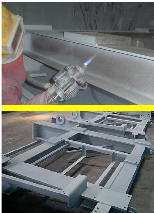
Foto 5 - Metalização em estrutura metálica eólica [Ref.: 10.q] / Foto 6 - Estruturas metálicas eólicas metalizadas [ Ref.: 10.q]
