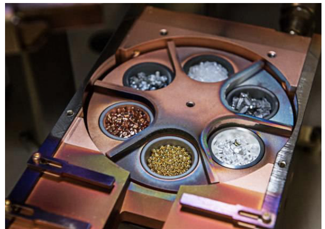
Exemplo de evaporador/sublimador por feixe de elétrons com diversos materiais a serem depositados em sequência.
