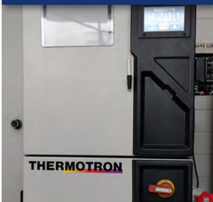
*Aparelho Thermotron realiza testes de ciclo térmico.*
