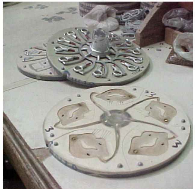
Exemplo de peças confeccionadas por centrifugação com borracha usada como molde.
