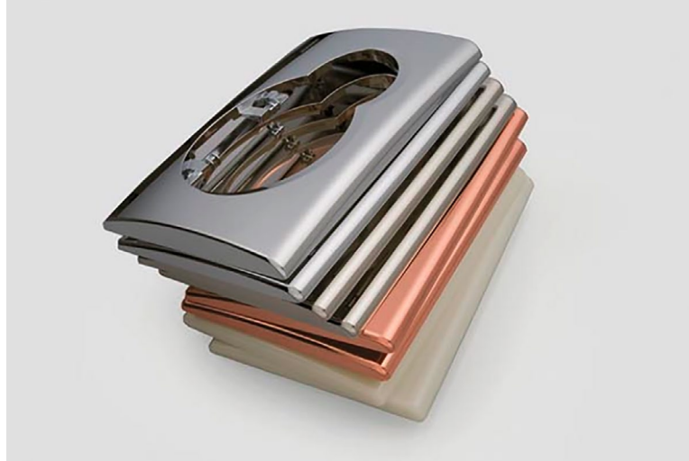
A eletrodeposição das camadas metálicas em uma superfície plástica não-condutora ocorre sobre a camada de níquel metal, obtida sem o suporte de uma corrente elétrica externa
