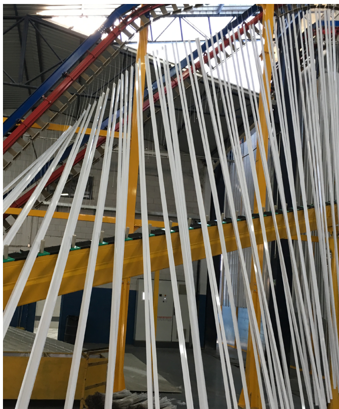
Linha de pintura vertical, mais produtiva que a linha horizontal
