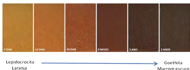
Figura 1 - Evolução da cor da pátina formada em amostras de aço patinável expostas na estação de corrosão do Instituto de Pesquisas Tecnológicas (IPT), na cidade de São Paulo, ao longo de 2 anos.
