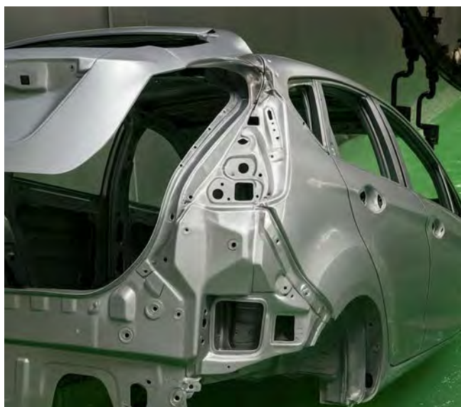
Carroceria de automóvel seguindo para o estágio de fosfatização tricatiônica
