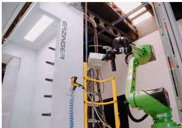
Cabine de pintura a pó em PVC com robô de pintura
