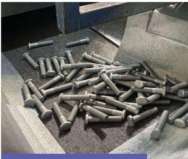
Fixadores no processo de Lamela de Zinco (Organometálico)
