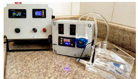
Figura 5 - Conjunto completo, fornecido pela PA8, para pesquisa dos custos da energia elétrica nos processos galvânicos e outros ensaios em Célula de Hull.
