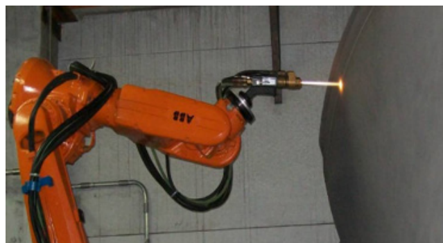
Foto 3: Pá de turbina Kaplan metalizada por HVOF.
