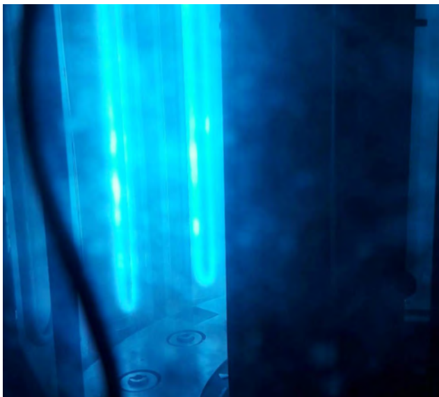
Visão de alvos sendo bombardeados por íons de argônio, o campo magnético é que faz o plasma ficar preso junto a ele (foto tirada pelo visor da porta)
