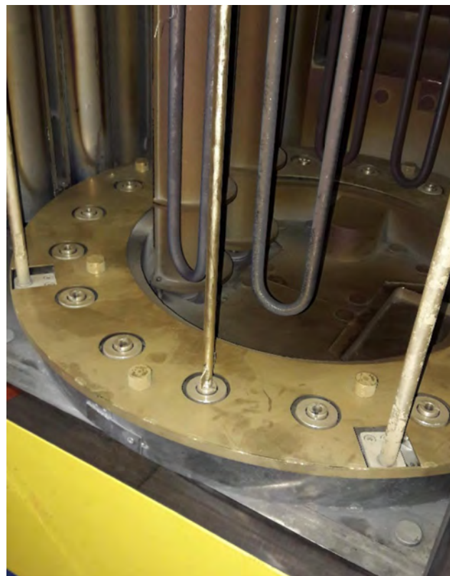
Interior de uma câmara após um ciclo de deposição de TiN
