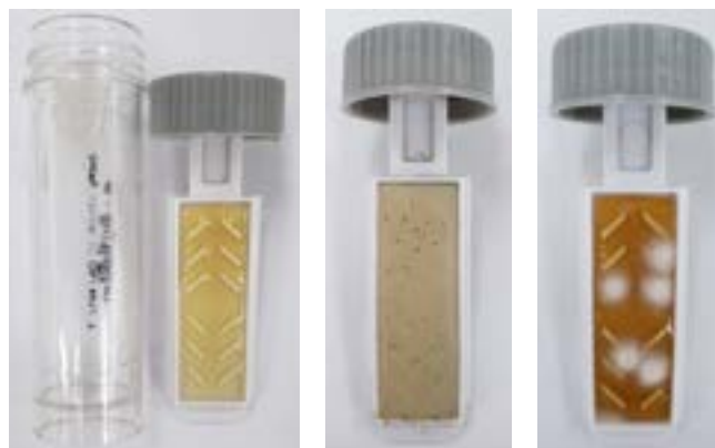
Figura 1: Exemplo de conjunto comercialmente disponível para avaliação microbiológica. À esquerda: conjunto recém-aberto, onde se observa um dos meios de cultura e o invólucro original; ao centro: meio de triptona soja ágar (TSA) apresentando contaminação bacteriológica (o meio de cultura encontra-se desidratado); à direita: extrato de malte apresentando contaminação por bolor.
