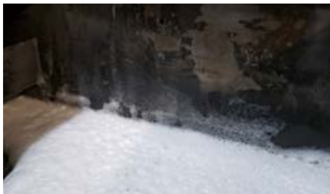
Figura 5: Resíduos de um biofilme retirado das paredes de um tanque de armazenamento de ultrafiltrado puro. À esquerda: visão geral de uma das paredes; à direita: raspas contendo o biofilme.
