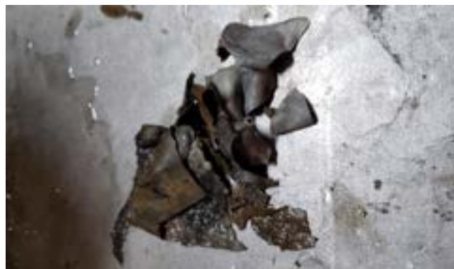
Figura 5: Resíduos de um biofilme retirado das paredes de um tanque de armazenamento de ultrafiltrado puro. À esquerda: visão geral de uma das paredes; à direita: raspas contendo o biofilme.
