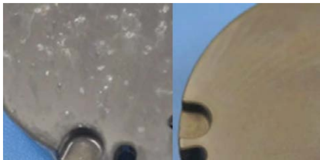
À esq.: EN AC 46000, sem proteção, após oito horas de ensaio em névoa salina. À dir.: EN AC 46000, com processo Iridite TCP III, após 120 horas de ensaio em névoa salina
