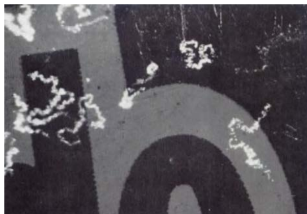
Figura 5 - Corrosão filiforme em chapa de alumínio causada por barreiras de vapor
