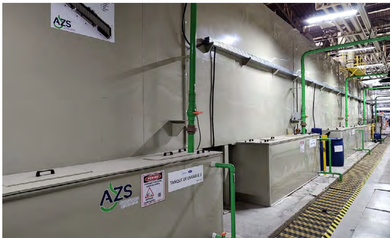
Túnel de Pré-Tratamento por Aspersão fabricado em Polipropileno (PP)
