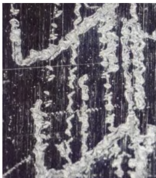
Figura 6 - Aspecto da corrosão filiforme após a remoção da camada de tinta. É possível observar o crescimento na direção da laminação
