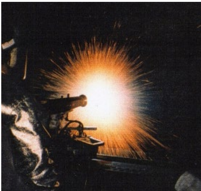
Foto 5 - Metalização a arco elétrico com deposição de aço inoxidável
