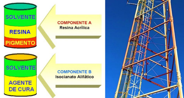
Desenho dos componentes de uma tinta de Poliuretano e uma torre pintada com Poliuretano DF
