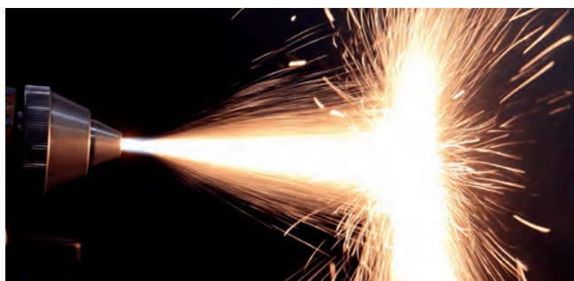
Metalização a arco elétrico (arc spray)
