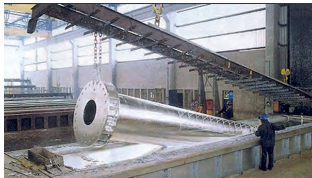
Processo de galvanização a fogo por batelada
