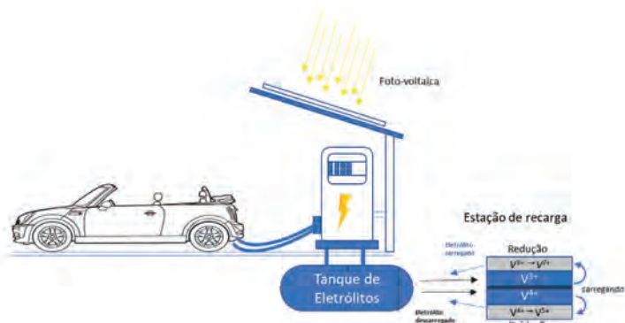
Figura 2 – Esquema de bateria de vanádio para veículo
