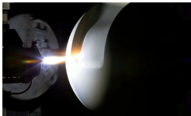
Aspersão Térmica - Aplicação em válvulas esféricas
